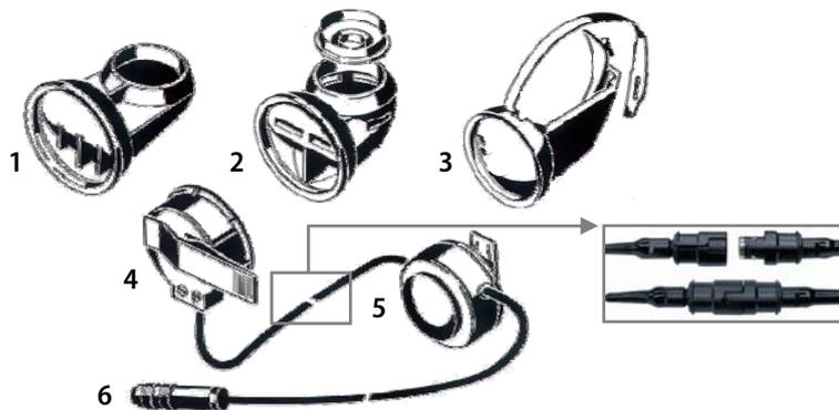
Für Kenwood TK 290 Funkgerät mit LEMO Trennkupplung ausgestattet. Diese ermöglicht es während des Ablegens der Ausrüstung den Mikrofon-Lautsprecher von der Sendetaste zu trennen ohne ihn vom Maskenadapter zu demontieren.
